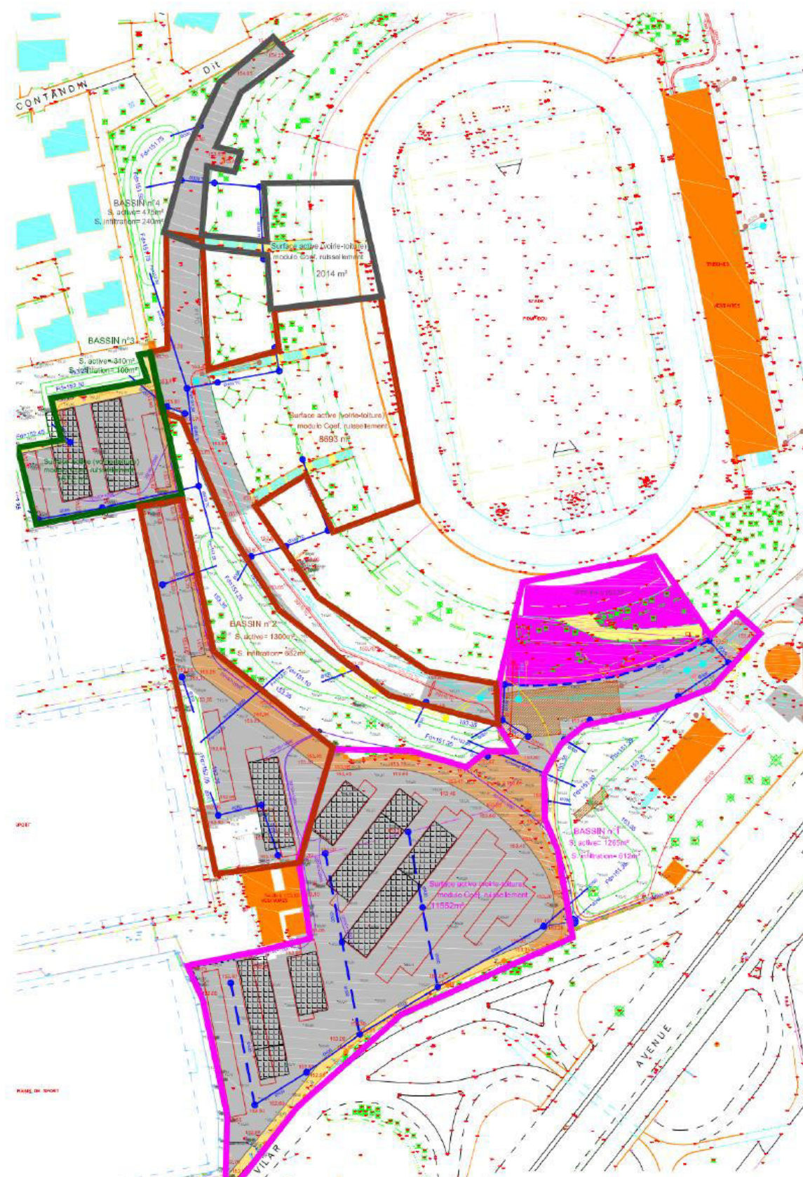
Figure 17 : Principe de récupération des eaux de pluie
