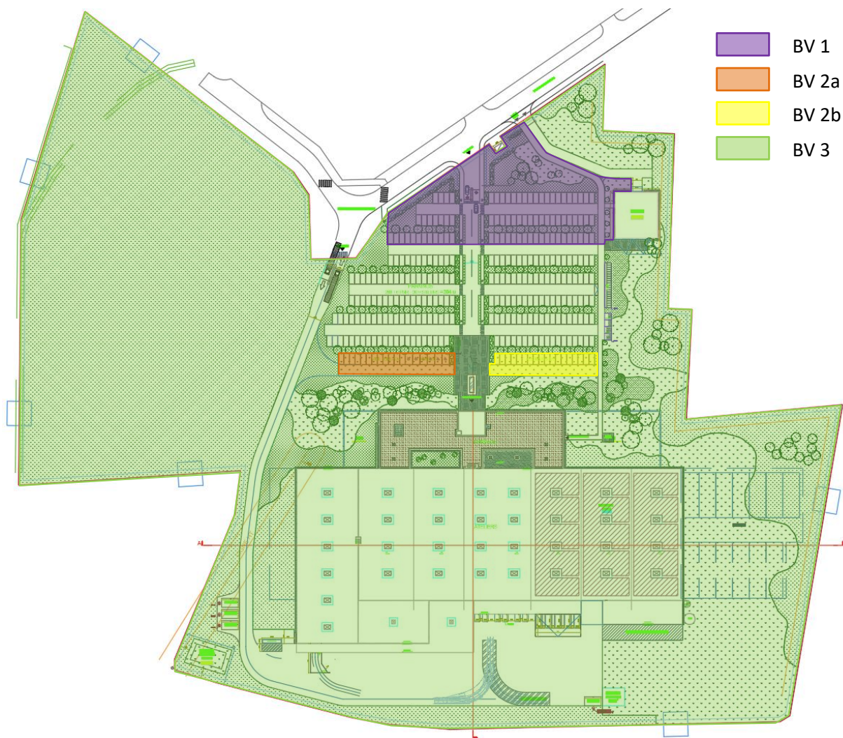
Figure 6 : Décomposition du projet en bassin versant (Source : SODEREF)
