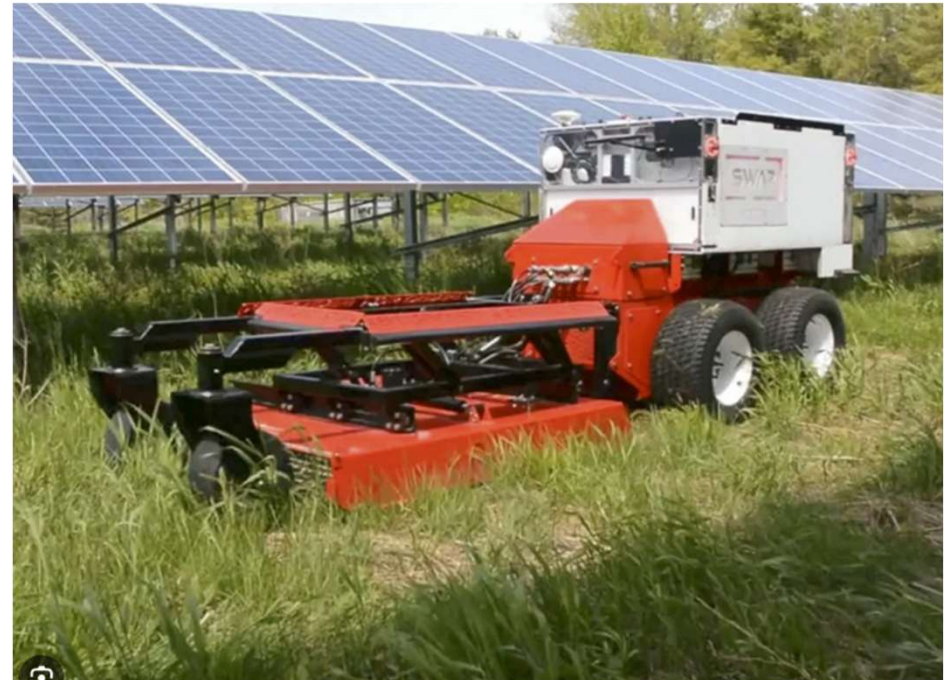
Entretien du terrain par tonte mécanique avec robot piloté et de basse hauteur pour passer sous les modules
