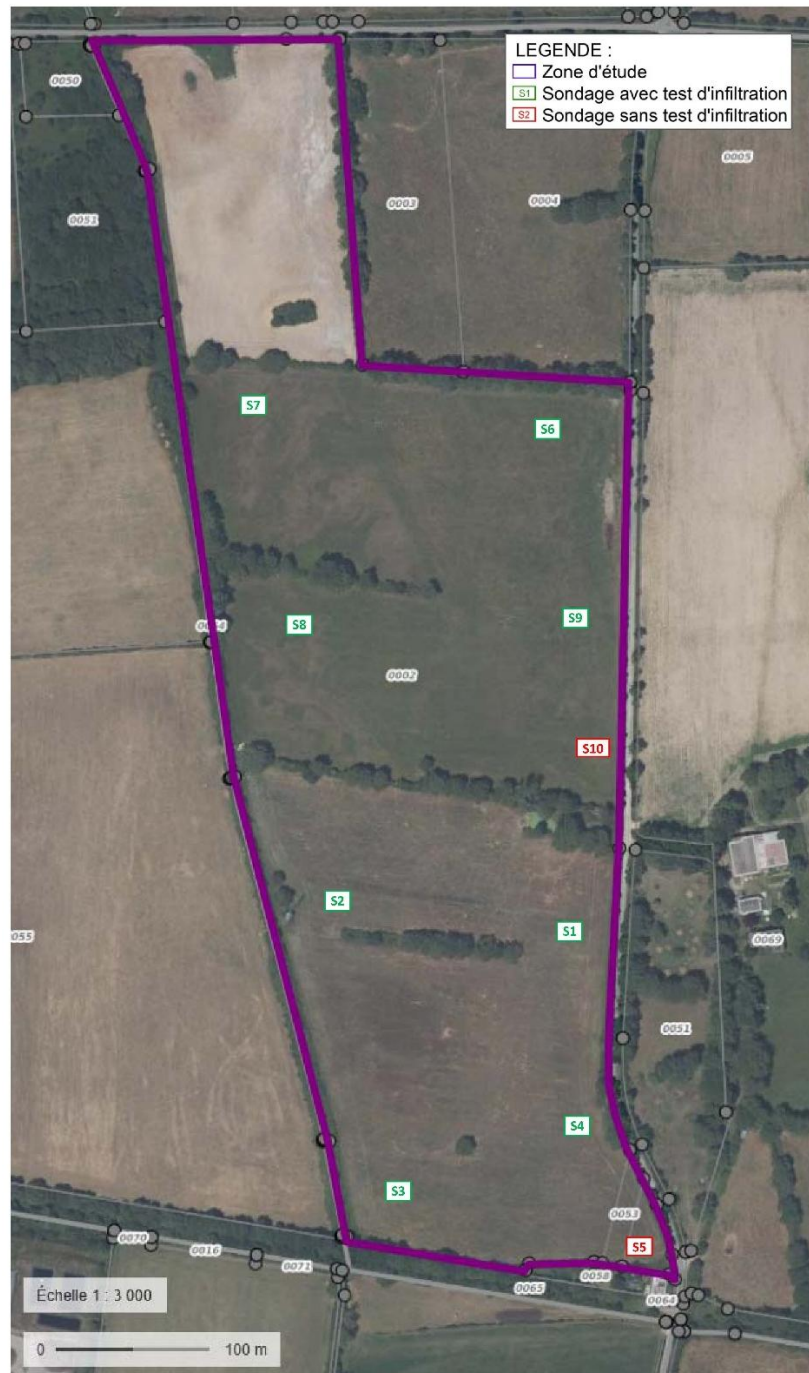
Figure 22: Localisation des sondages réalisés (source : SOND&EAU)
