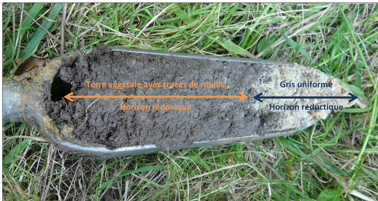
Figure 2 : Exemple d'un sondage dans un sol hydromorphe
