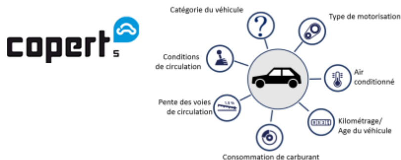
Figure 3 : Paramètres utilisés dans la méthodologie COPERT pour le calcul des émissions liées au trafic routier
