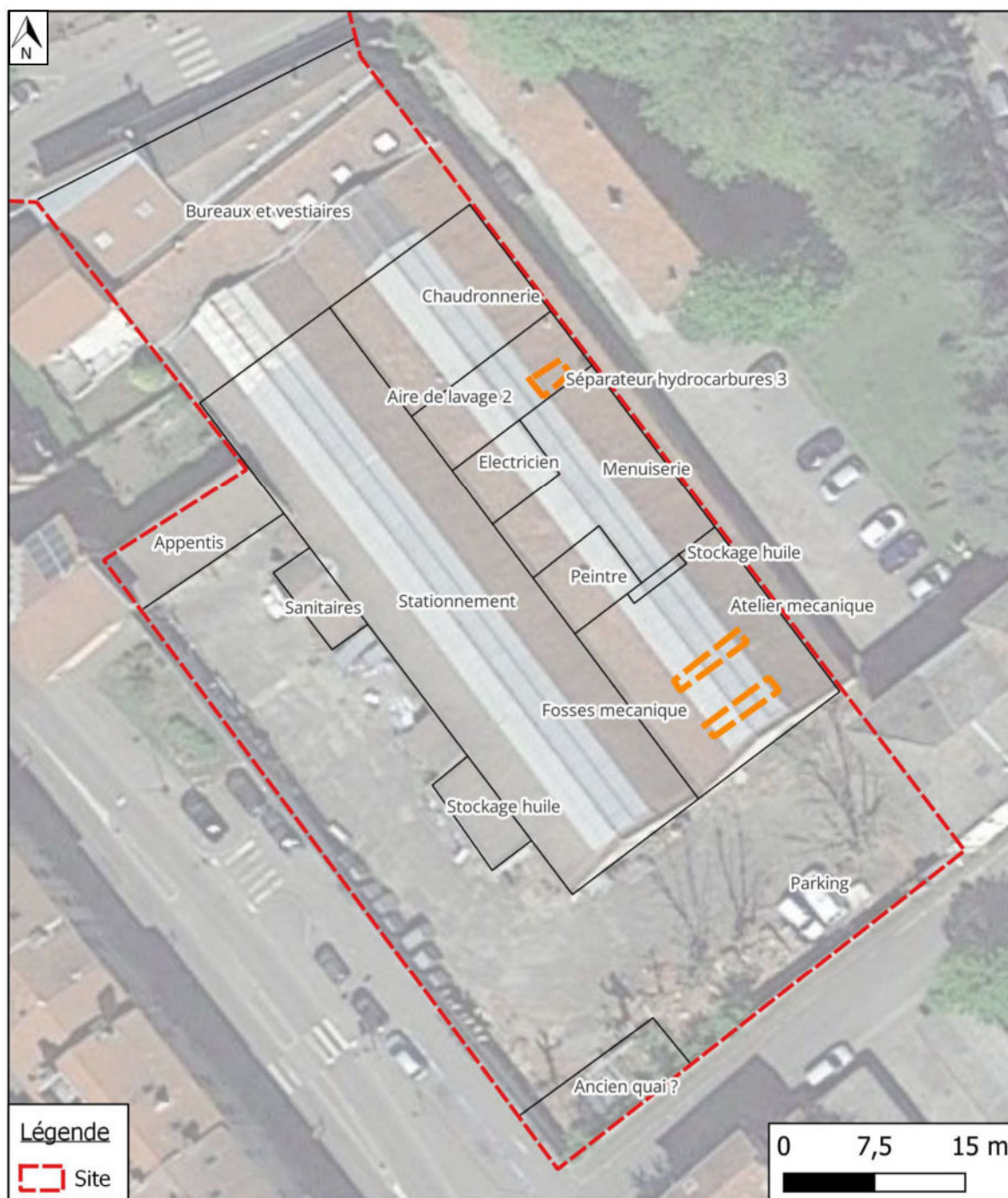
Figure 6 : Entités et installations recensées lors de la visite de site – CTM2
