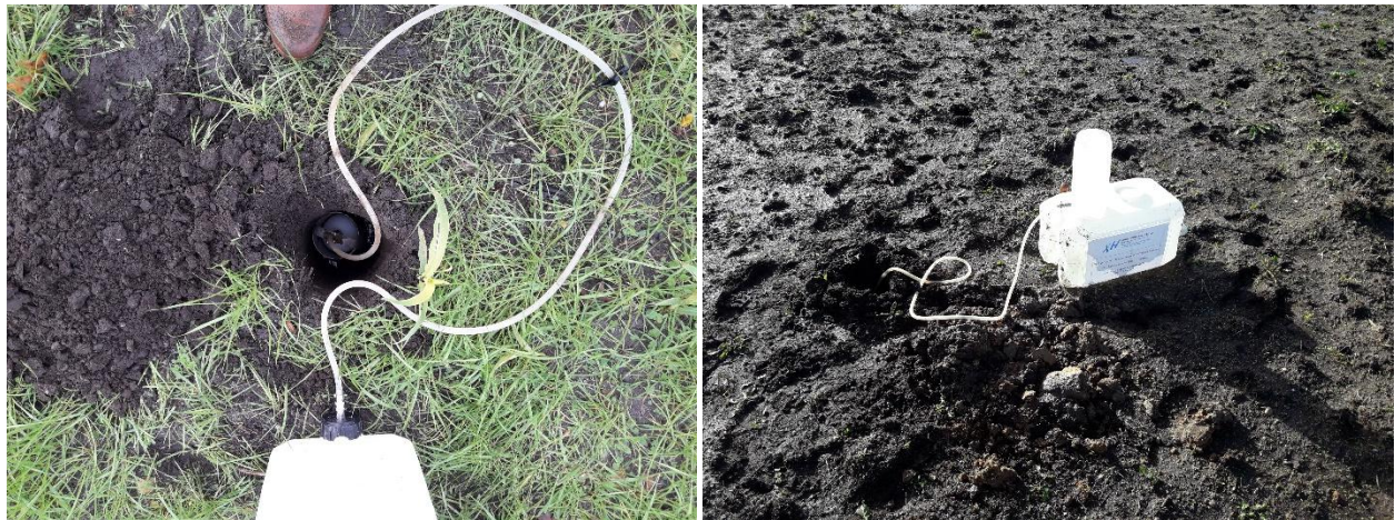
Mise en œuvre des tests d'infiltration à Montbert
