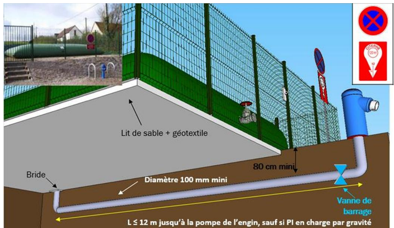
Figure 78 : Schéma avec dispositif d'aspiration par poteau (source : Fiche n° 11c du RDDECI de l'Hérault)
