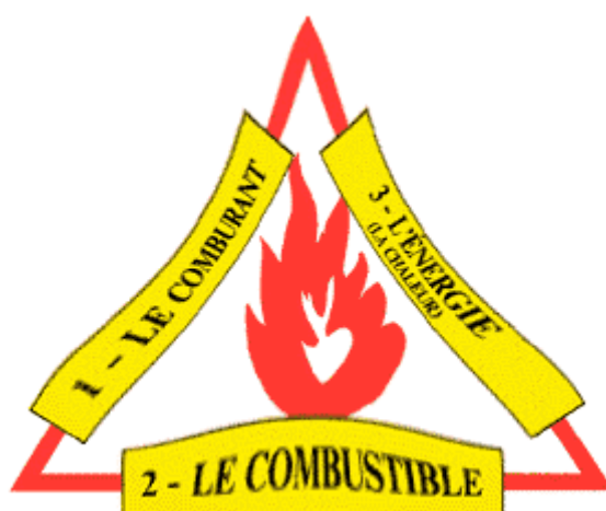
Figure 71 : Eléments nécessaires pour le déclenchement d'un incendie
