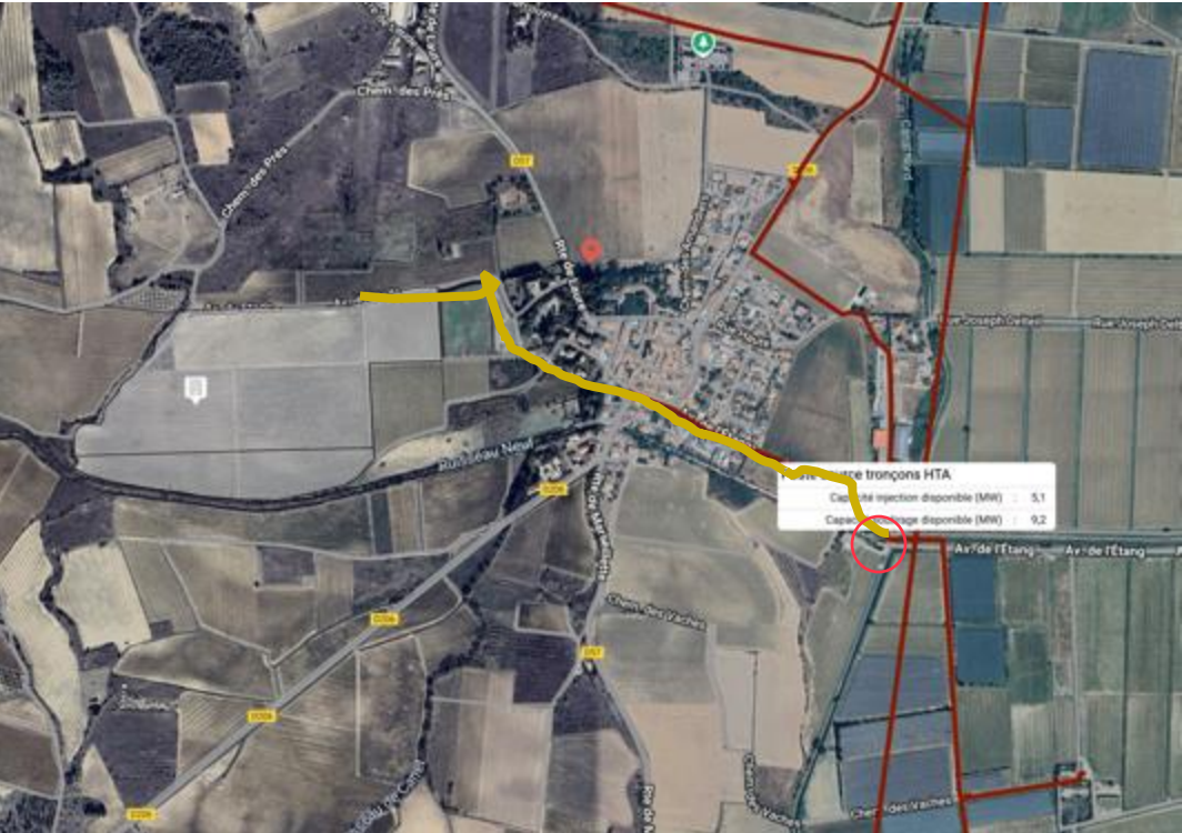
Capacité d'injection de 5,1 MW- distance 1,2 km
