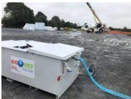
Système de traitement des eaux de chantier
