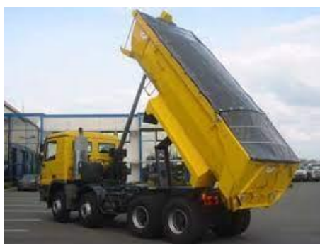
Système de bâchage sur les camions
