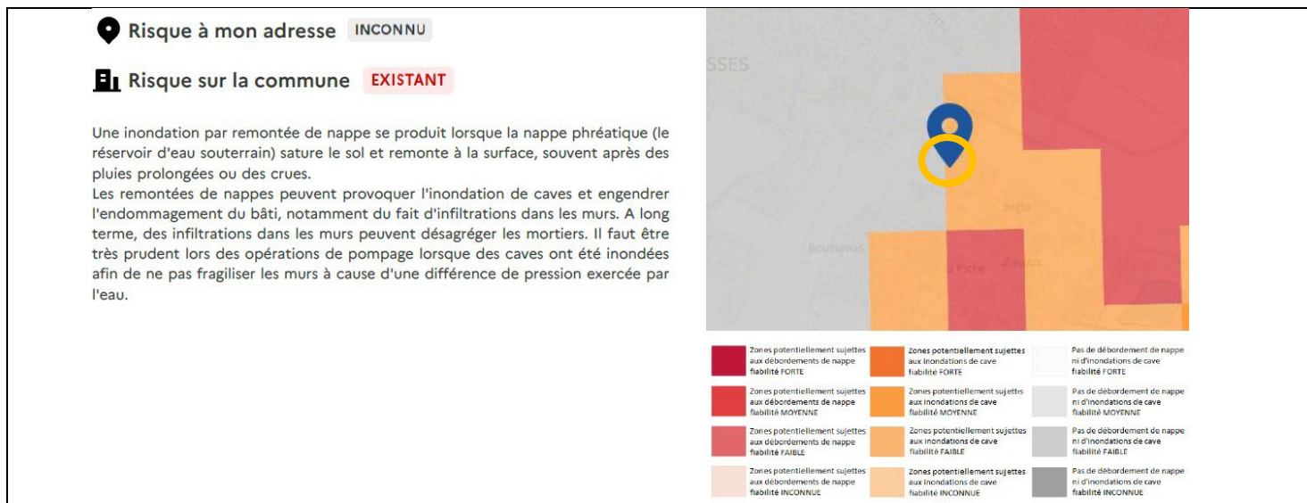
Fig. 6 – Inondation de nappe : sensibilité du site faible à inexistante (sédiment). On se situe à la limite de la basse terrasse (en gris) peu sensible aux inondations avec la basse plaine, alimentée par la terrasse supérieure, les rivières et ouvertes de nombreuses gravières, donc plus sensible aux remontées de nappe (de couleurs orange et rouge).
