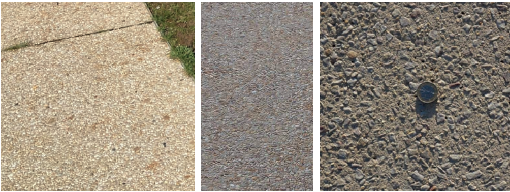
Béton micro-désactivé // ciment gris clair / granulats roulés ou concassés dans les teintes ocre
