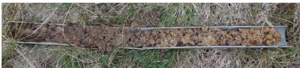
Figure 5 : Exemple d'une carotte de terre réalisée pour donner suite à un sondage
