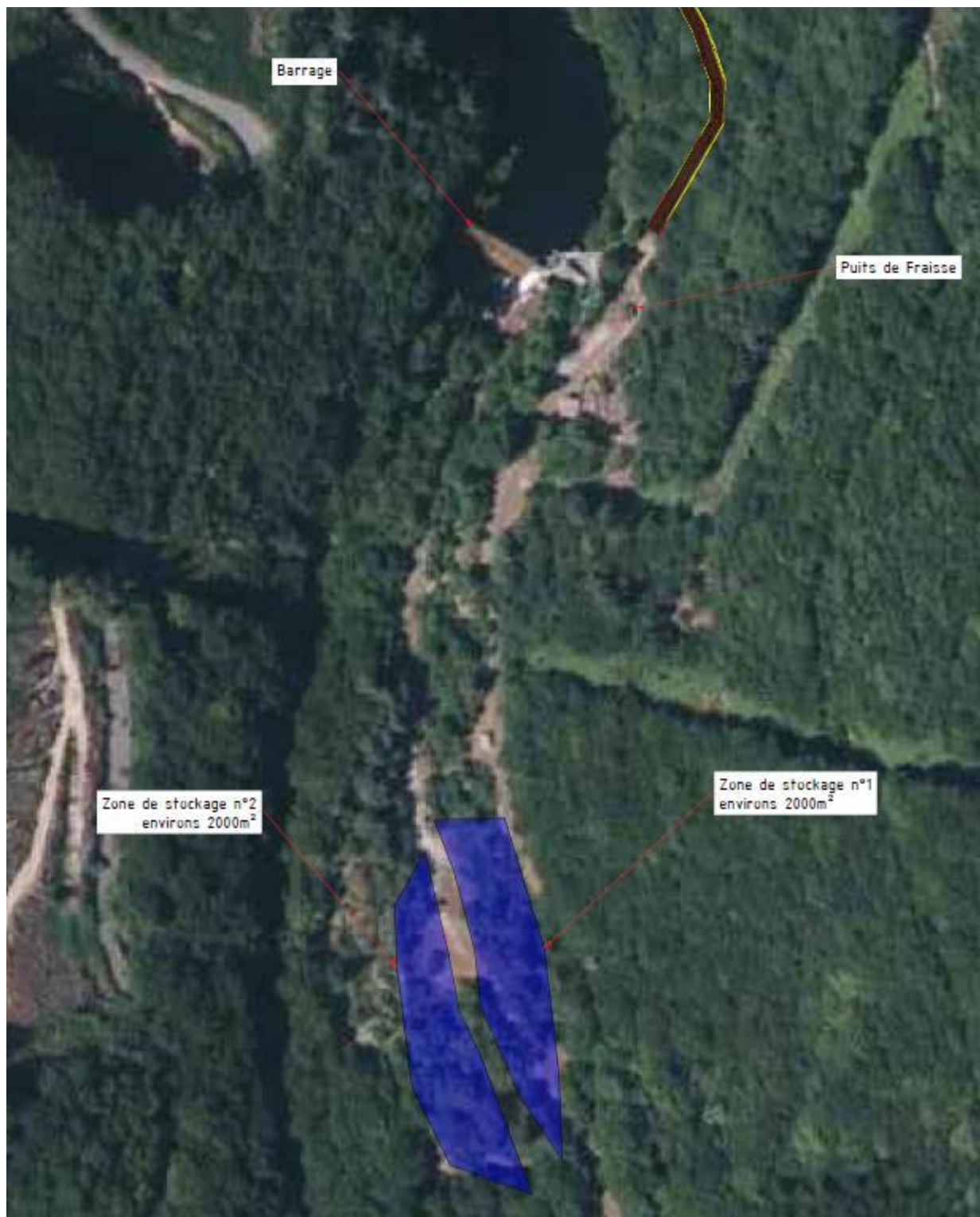
Figure 2 Plan des zones de stockage de sédiments
