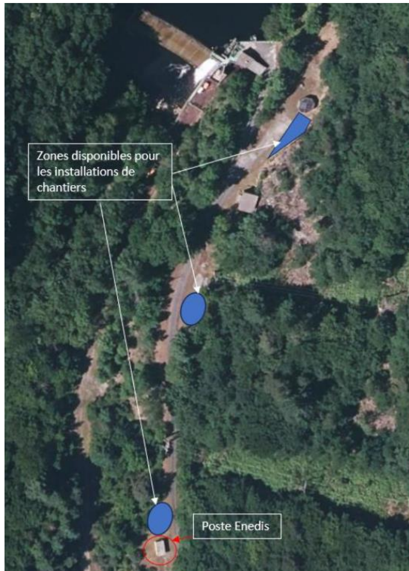
Figure 7 : Implantations possibles des installations de chantier
