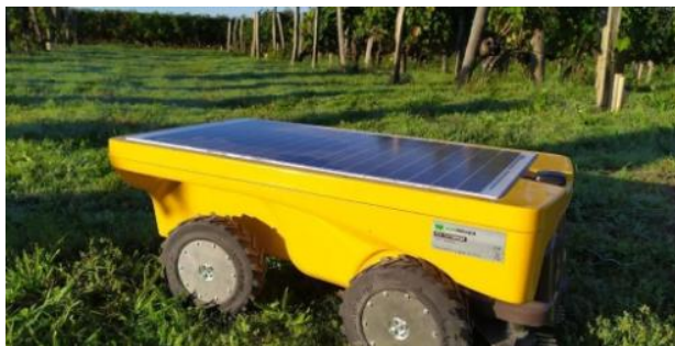
Figure 2 : Robot dédié à l'entretien des parcelles solarisées
