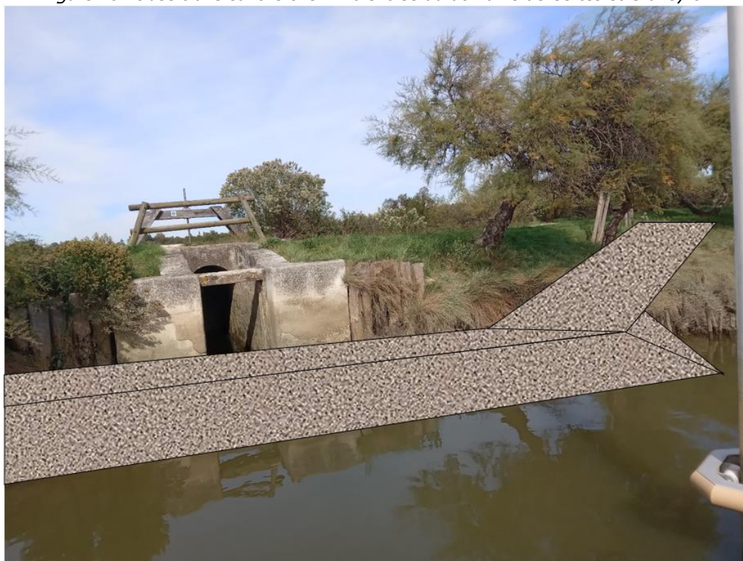
Figure 11 Création d'un passage au niveau de l'écluse
