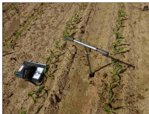
Exemple de tarière enfoncée dans le sol (refus)
