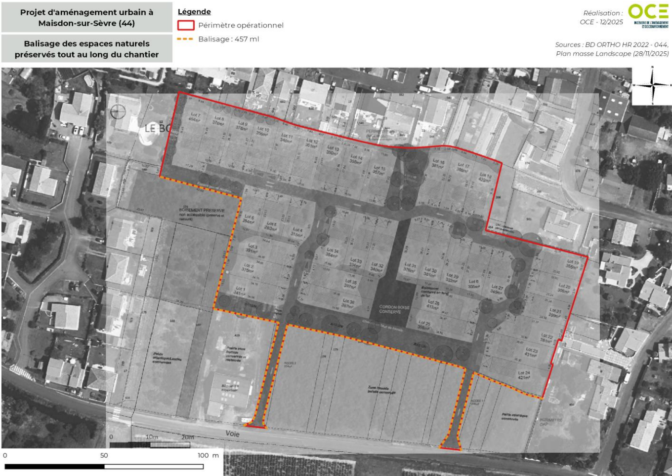
Figure 5 : Balisage des zones sensibles en phase chantier
