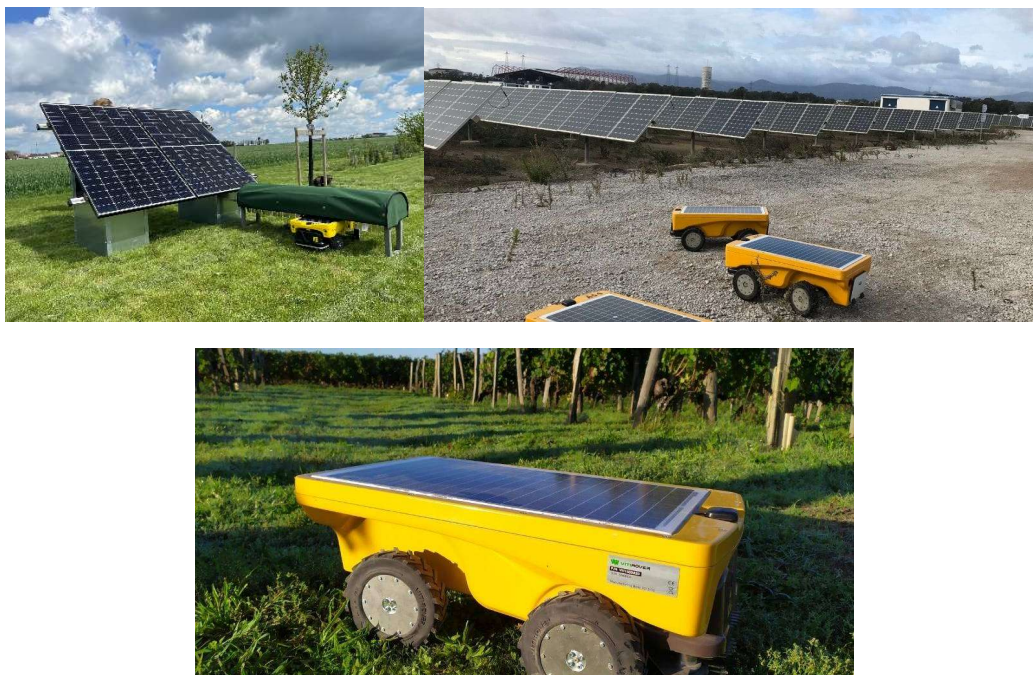
Figure 17 robot dédié à l'entretien des parcelles solarisées
