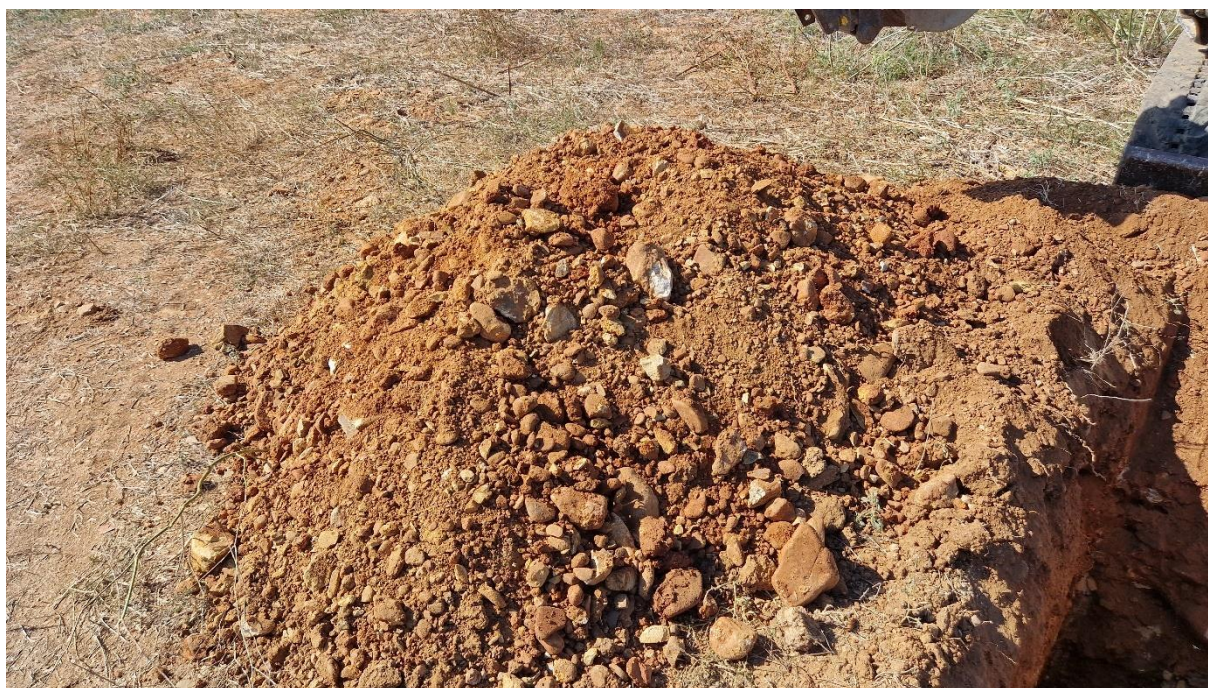
Photo 1 : Argile marron graveleuse de surface
