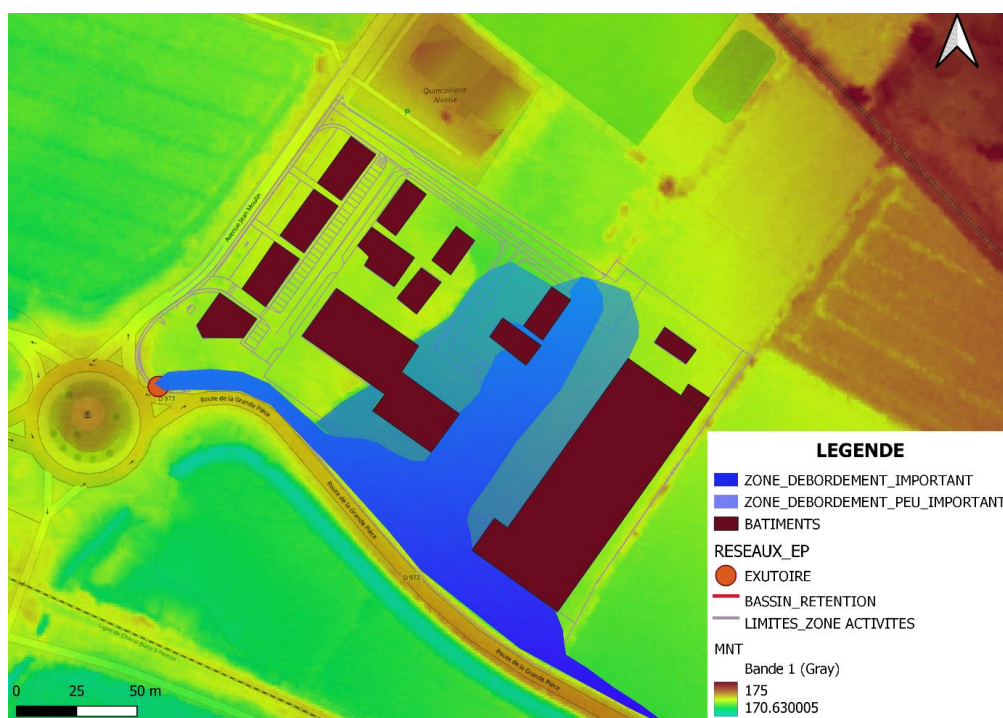
Figure 16 : Zone de débordement du bassin de rétention pour une crue > décennale
