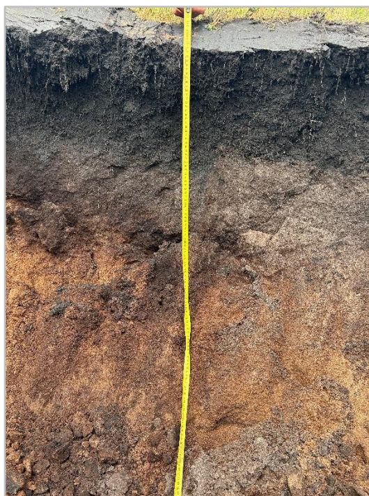
Photo 9 : Profil pédologique d'un PODZOSOL HUMIQUE à texture sableuse – Photo prise sur site, © Rainette, 2025
