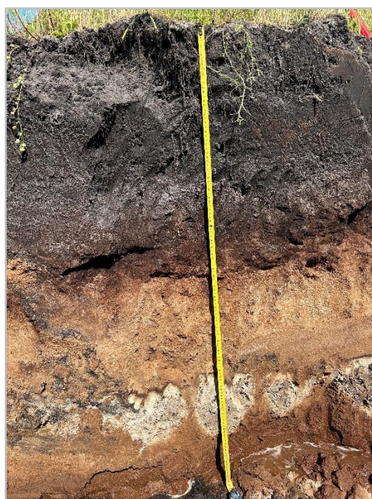
Photo 4 : Profil pédologique d'un PODZOSOL HUMO-DURIQUE à texture sableuse – Photo prise sur site, © Rainette, 2025
