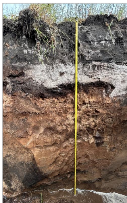
Photo 7 : Profil pédologique d'un PODZSOL MEUBLE à texture sableuse – Photo prise sur site, © Rainette, 2025
