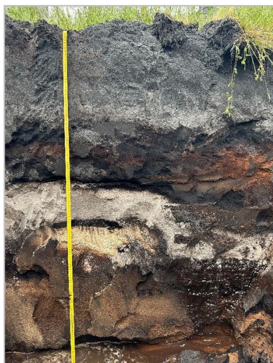
Photo 5 : Profil pédologique d'un PODZOSOL MEUBLE à texture sableuse – Photo prise sur site, © Rainette, 2025
