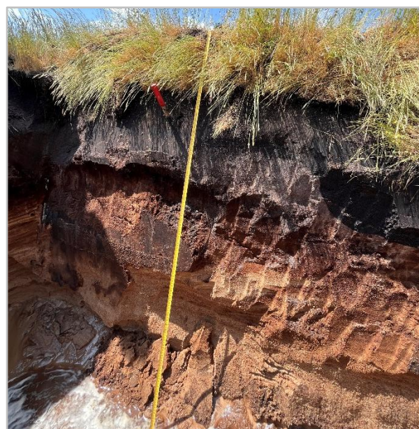
Photo 10 : Profil pédologique d'un PODZOSOL HUMO-DURIQUE à texture sableuse – Photo prise sur site, © Rainette, 2025
