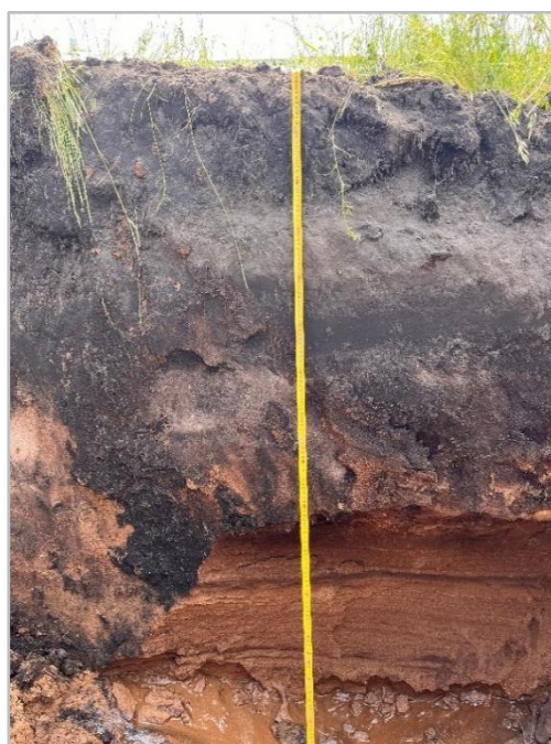
Photo 11 : Profil pédologique d'un PODZOSOL HUMO-DURIQUE à texture sableuse – Photo prise sur site, © Rainette, 202
