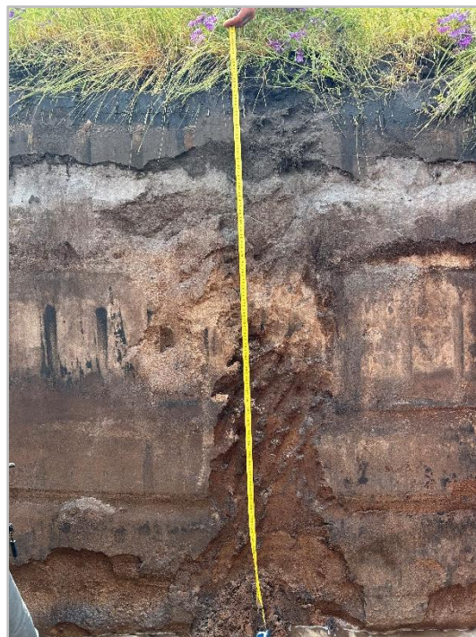
Photo 6 : Profil pédologique d'un PODZOSOL MEUBLE à texture sableuse – Photo prise sur site, © Rainette, 2025
