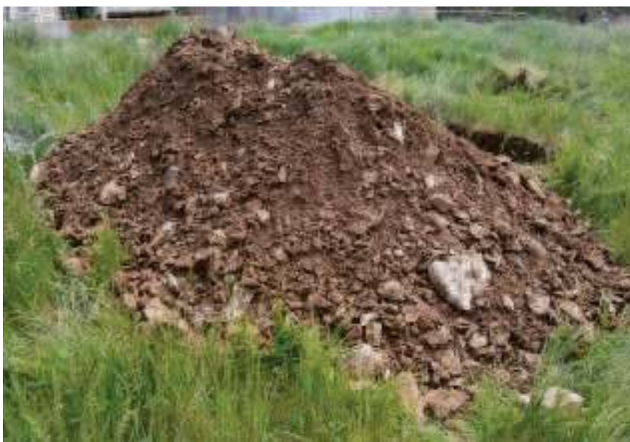
Déblais du sondage S1
