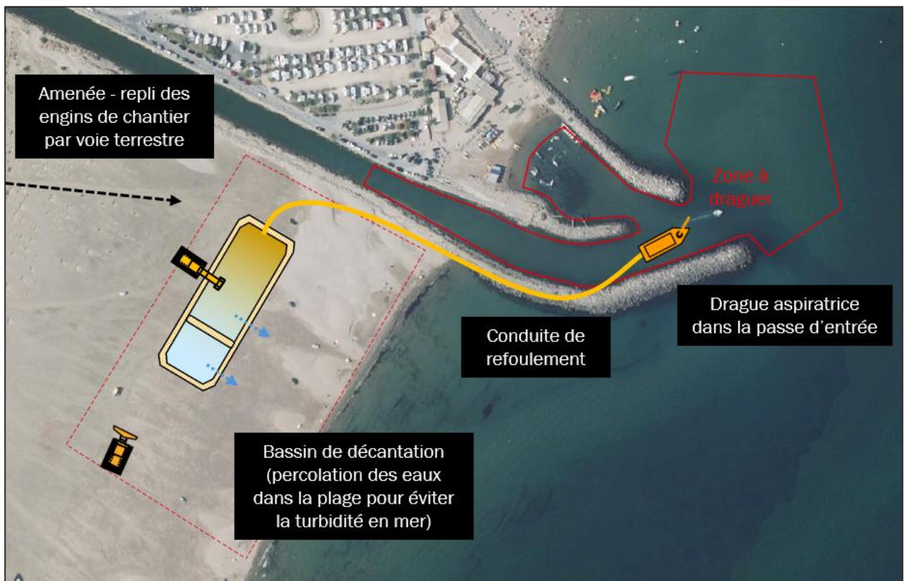
Schéma de principe des travaux de dragage dans la passe d'entrée du Grazel et rechargement de la Plage de la Vieille Nouvelle
