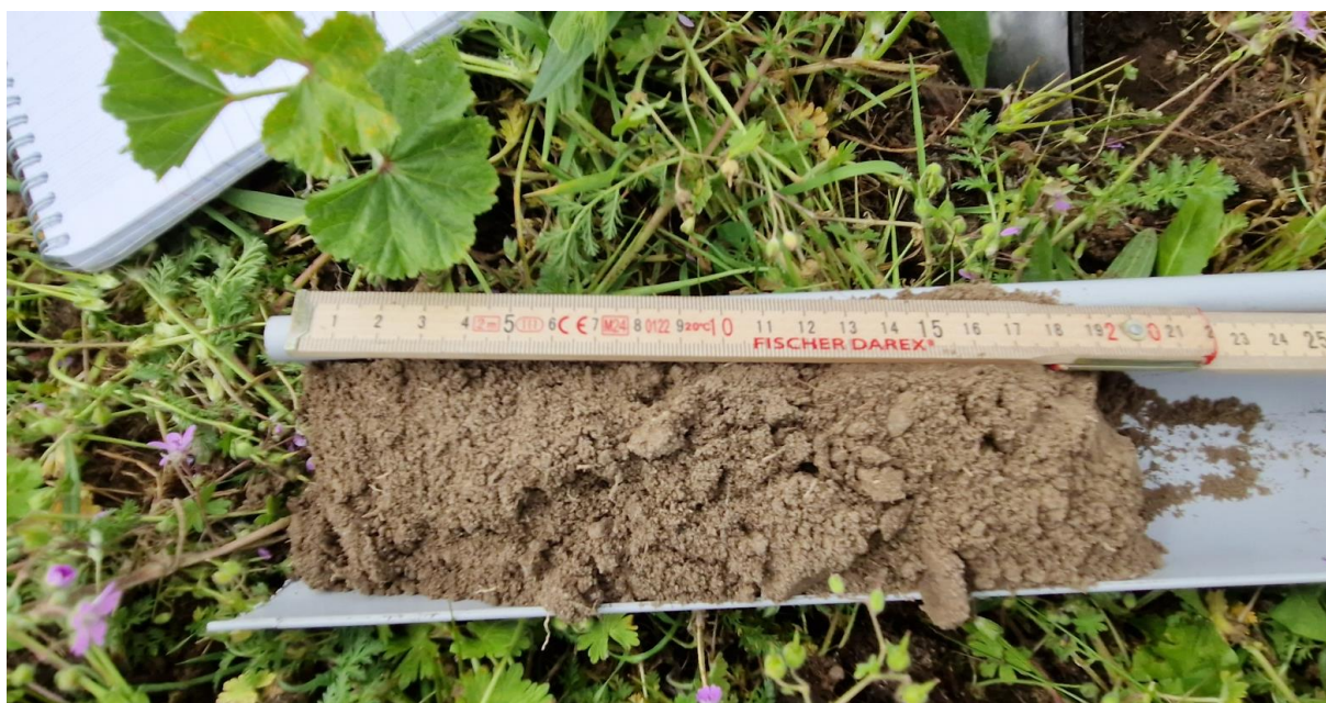
Figure 27 : Sondage 4 – pas de trace d'hydromorphie – refus à 20 cm – présence de galet rond – matrice très fine, très sèche, pas de matière organique même en surface
