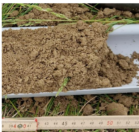
Figure 31 : Pas de trace d'hydromorphie au niveau de ce sondage – très homogène, moins de cailloux, galets, matière organique seulement sur les 5 premiers centimètres
