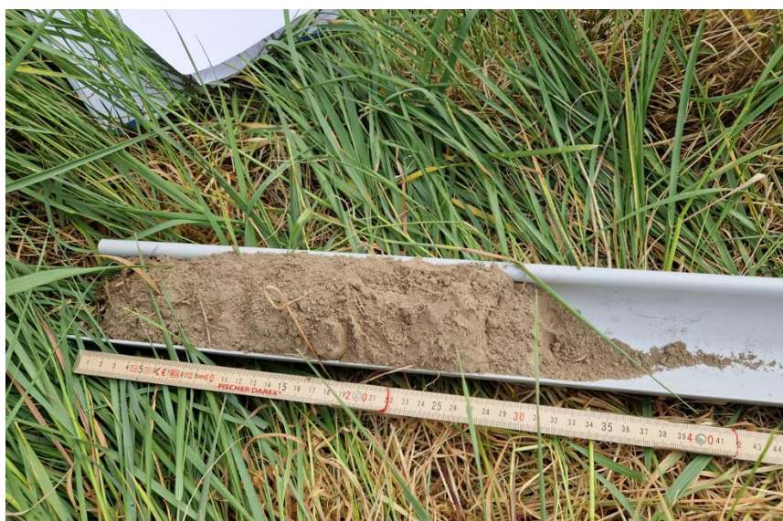
Figure 23 : Sondage 2 – sans trace d'hydromorphie – matériaux très fins, doux, friables et secs
