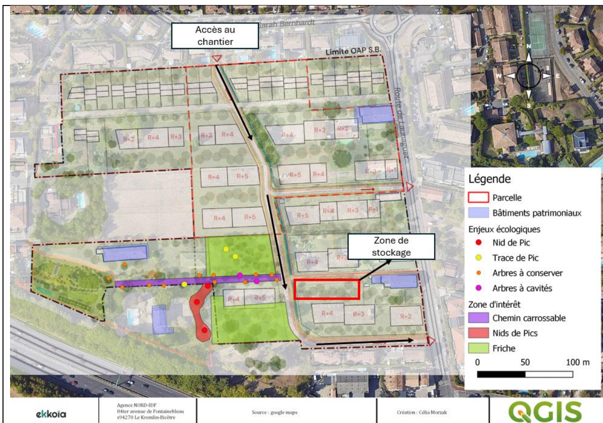
Figure 34 : Accès au chantier et zone de stockage
