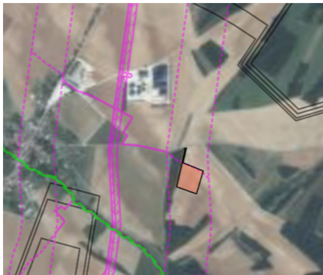
Figure 15 : Site E2 et servitude d'utilité publique - tampon canalisation de gaz en pointillé rose (source : Géoportail de l'Urbanisme)
