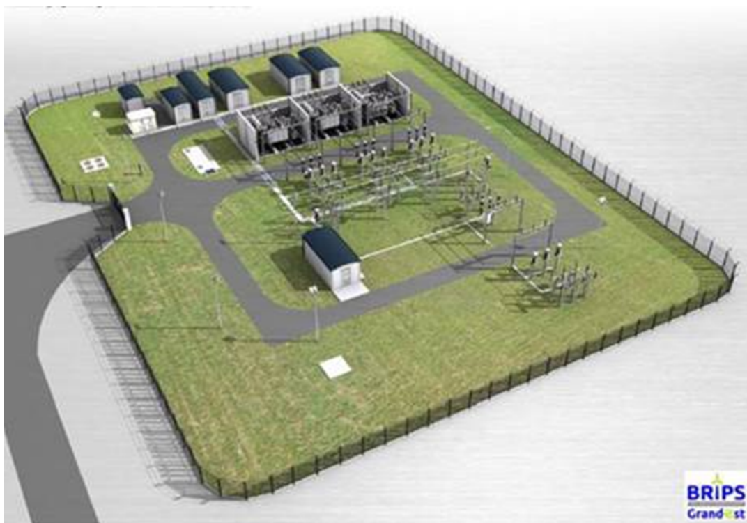
Figure 25 : Exemple d'un poste source 225 000 / 20 000 volts
