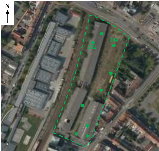
Figure 67 : Cartographie des pollutions sur le secteur de la cour de la petite vitesse (en mg/kg)
