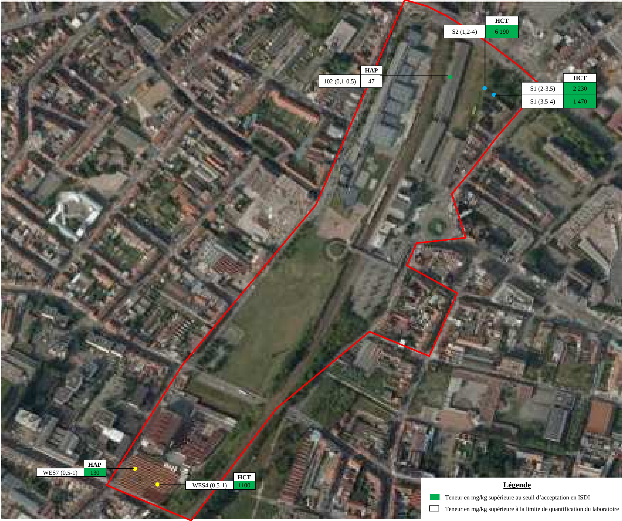
Figure 70 : cartographie de la pollution par les hydrocarbures
