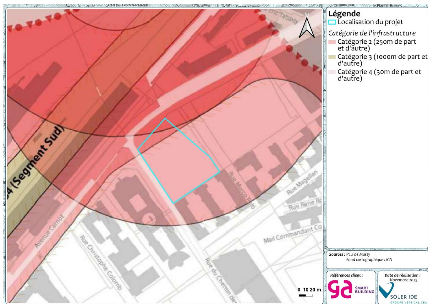
Figure 11 : Périmètre d'isolement acoustique par type d'infrastructure
