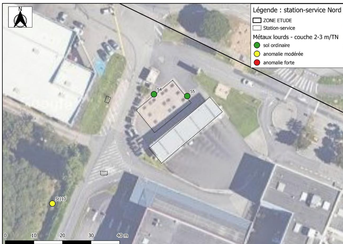
Figure 13 : Carte de répartition des métaux lourds 2-3 m/TN – station-service Nord
