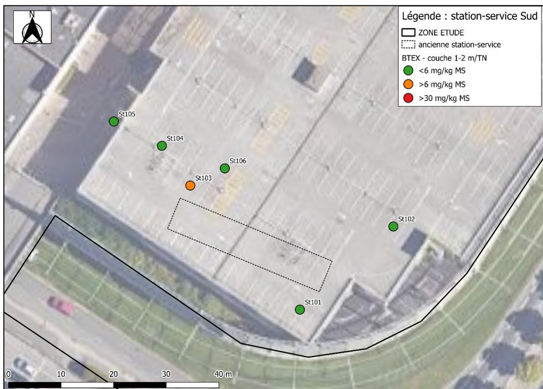
Figure 25 : Carte de répartition des BTEX dans les sols (1-2 m/TN) – station-service Sud
