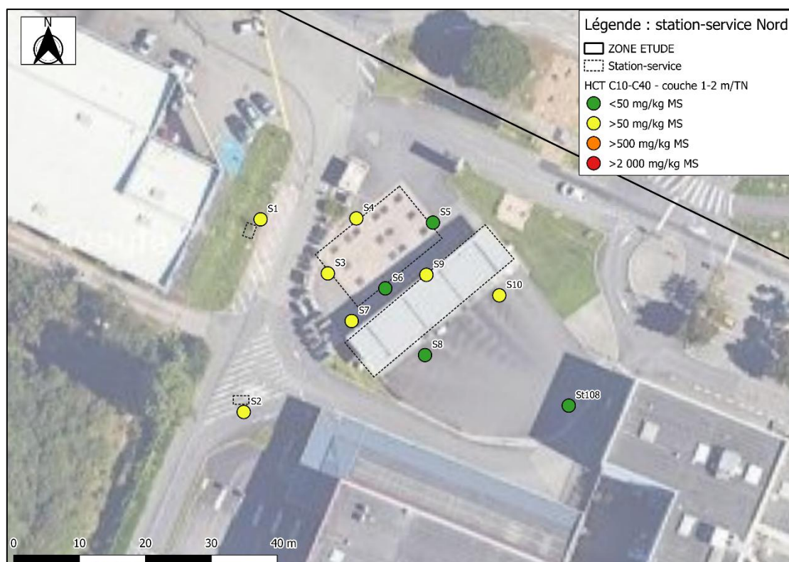
Figure 17 : Carte de répartition des HCT C 10 -C 40 dans les sols (1-2 m/TN) – station-service actuelle
