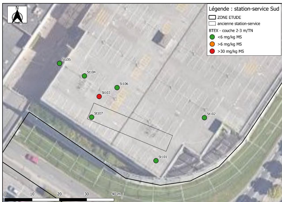
Figure 26 : Carte de répartition des BTEX dans les sols (2-3 m/TN) – station-service Sud
