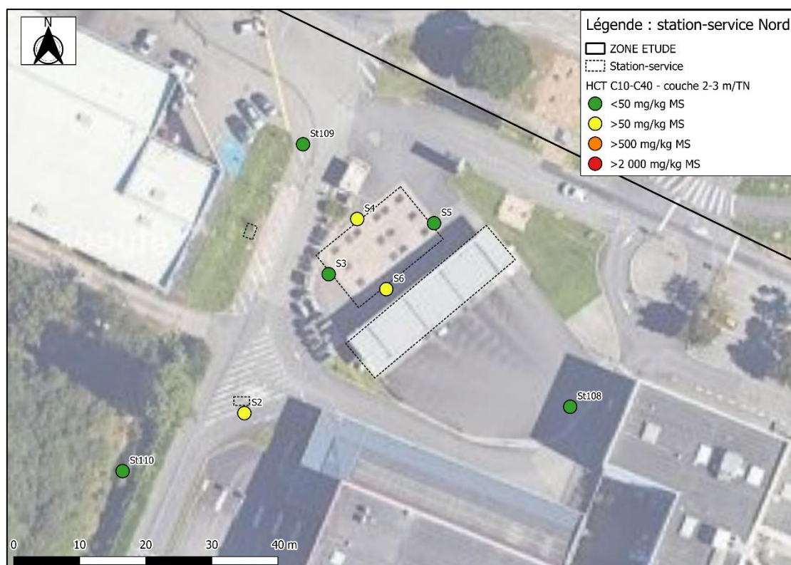
Figure 18 : Carte de répartition des HCT C 10 -C 40 dans les sols (2-3 m/TN) – station-service actuelle
