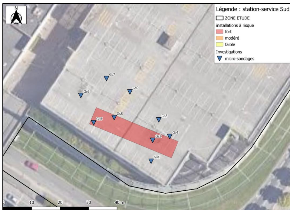
Figure 8 : Localisation des micro-sondages au droit de la station-service Sud
