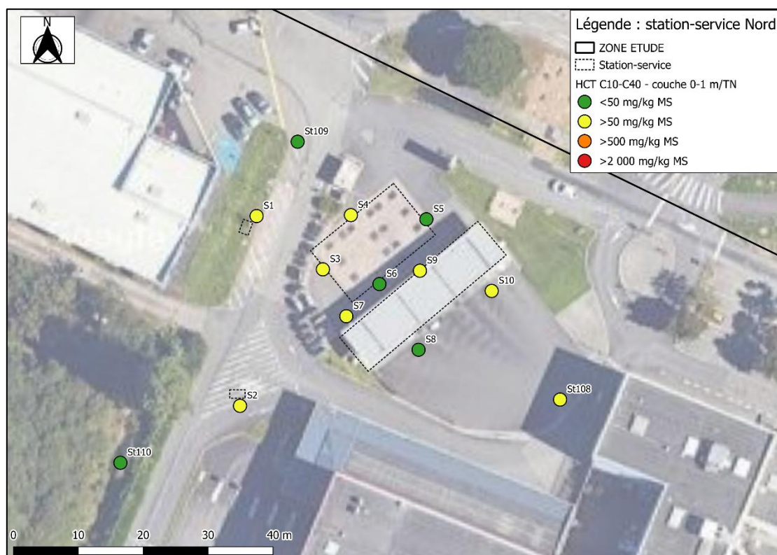
Figure 16 : Carte de répartition des HCT C 10 -C 40 dans les sols (0-1 m/TN) – station-service actuelle
