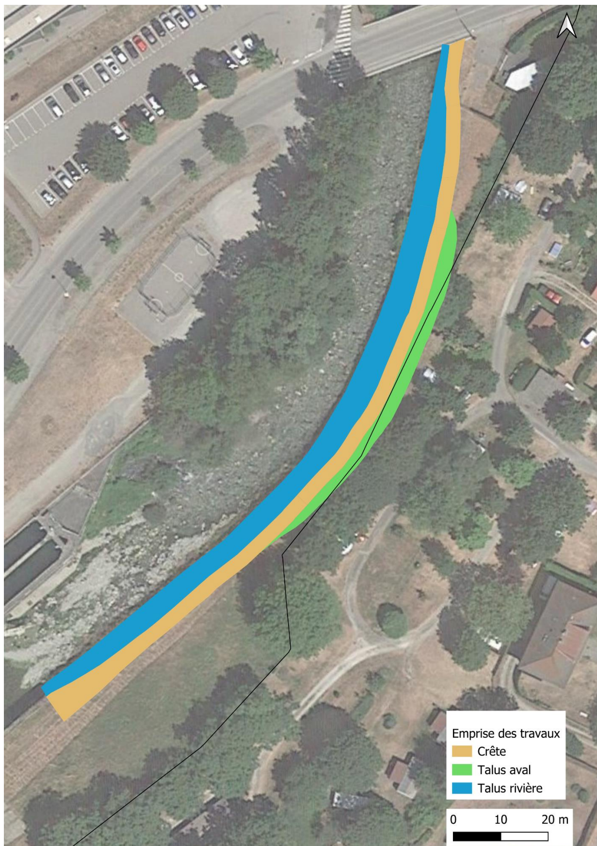
Figure 47 : Emprise des travaux
