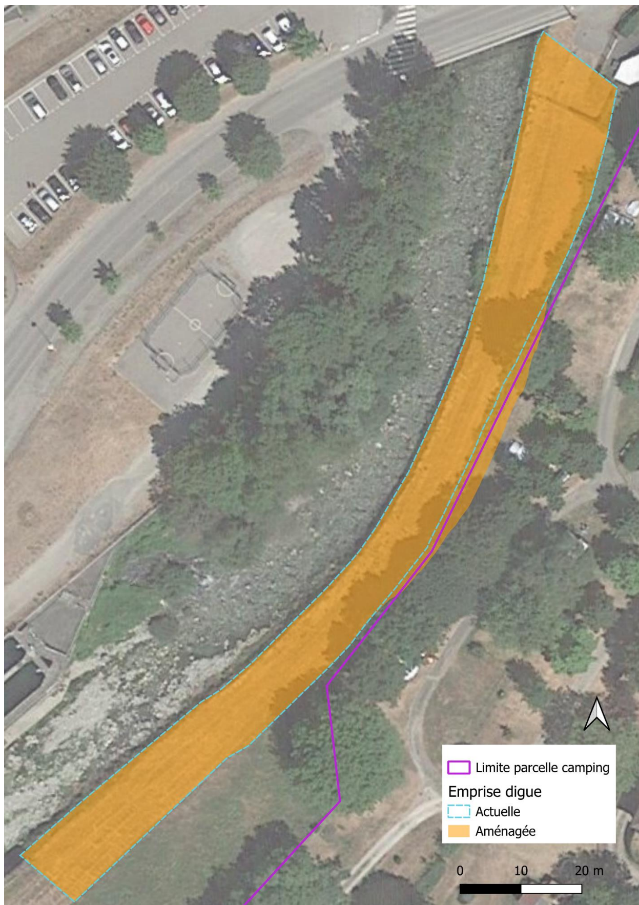
Figure 46 : Emprise de la digue en état actuel et aménagé
