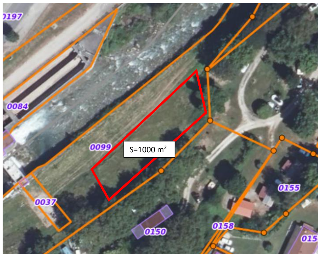
Figure 63 : Utilisation de la parcelle 99 pour stockage et circulation des engins
