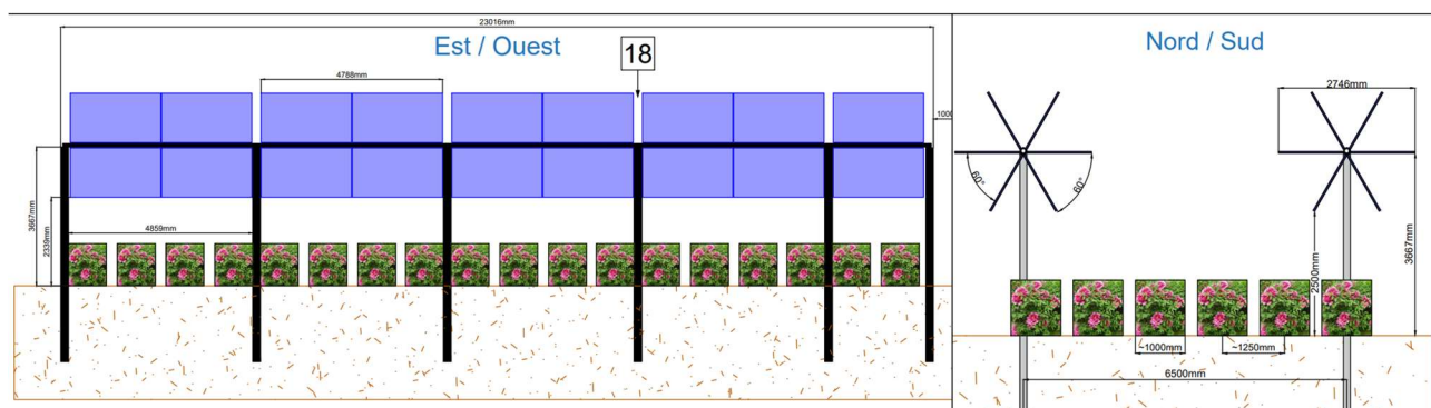
Figure 5: Plan de coupe E/O et N/S des installations agrivoltaïques
