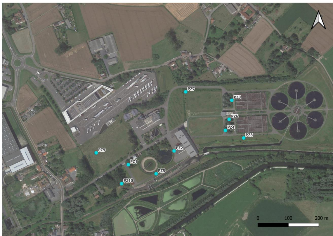
FIGURE 62 LOCALISATION DES PIÉZOMÈTRES SUR LE SITE DE LA STEU EN 2022 PAR FONDASOL
