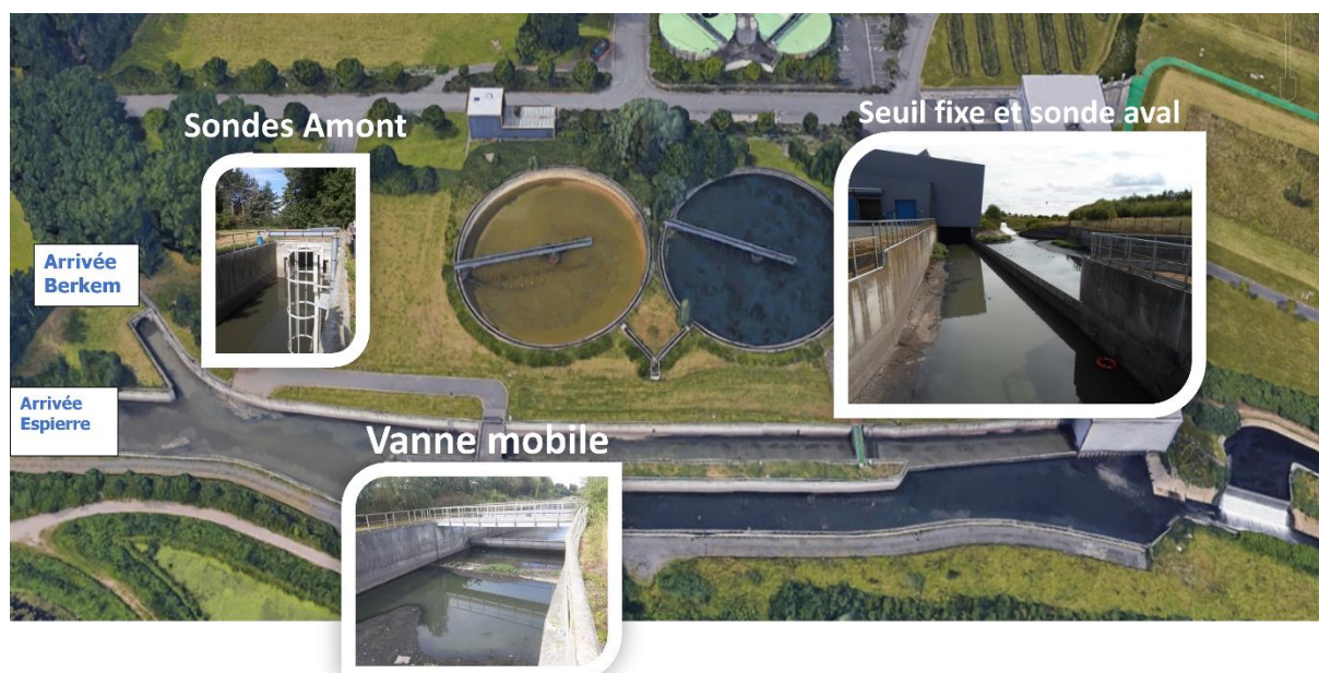
FIGURE 6 - PILOTAGE DES ORGANES D'ÉCRÈTAGE SUR LE CANAL
