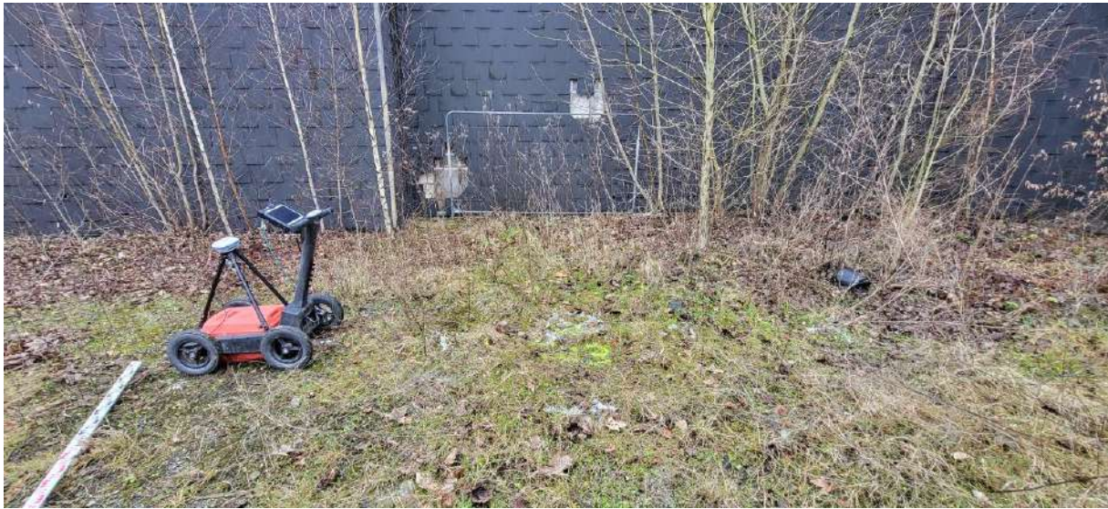
Figure 4 : Antenne Géoradar double fréquence et marquage au sol
