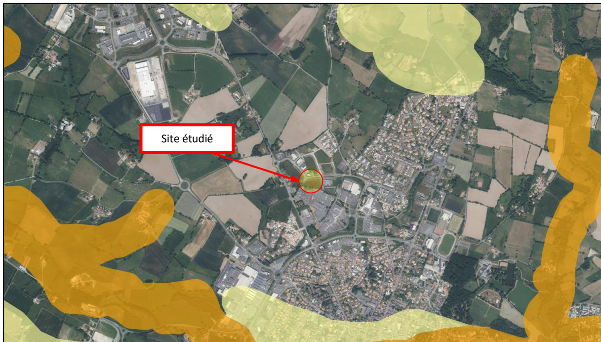
Risque vis-à-vis du retrait/gonflement des argiles (source : infoterre, BRGM)
