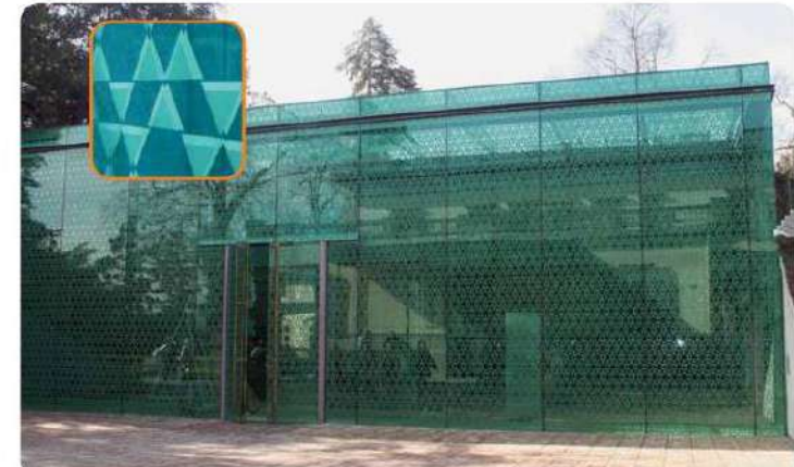
Cette nouvelle annexe du Musée Rietberg de Zurich se situe au milieu du parc. Pour différentes raisons, dont la protection des oiseaux, elle a entièrement été réalisée avec un verre imprimé et a été appelée «Émeraude». Un vrai bijou!
