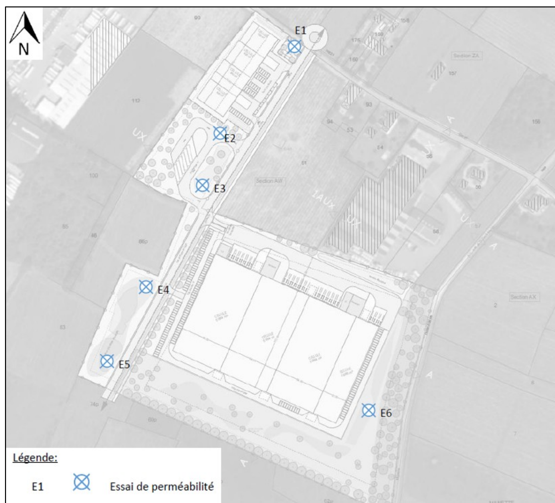
Figure 10 : Plan de localisation des sondages géotechniques
