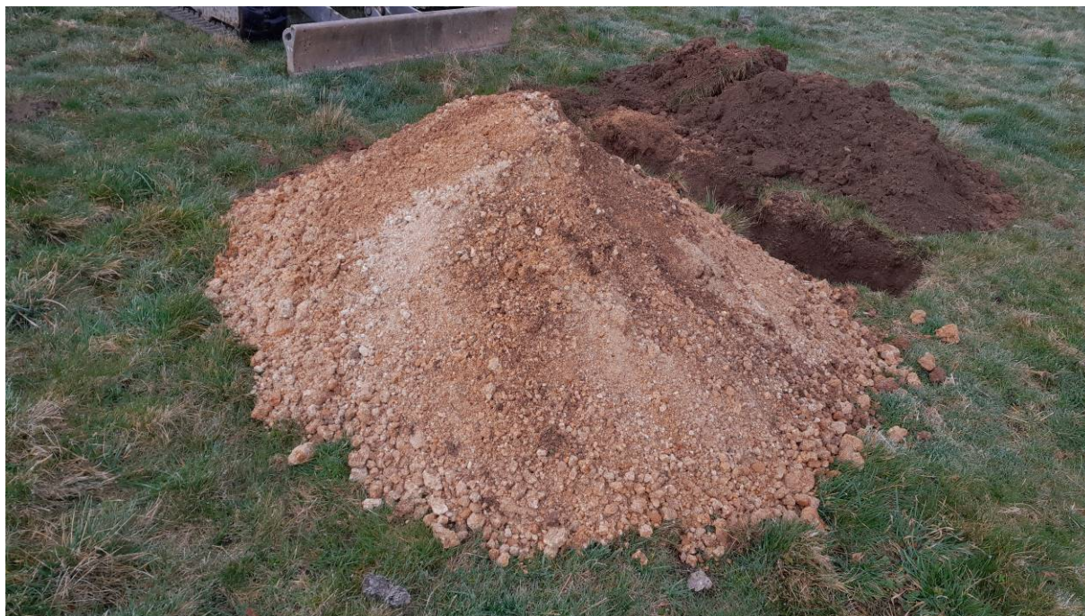
0.7-1.5 m : Sable graveleux beige de plus en plus graveleux et compact (arène granitique)
