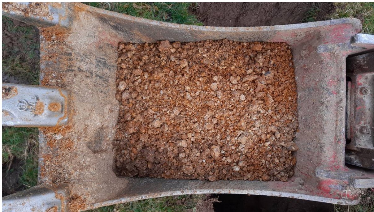
1.9-2.0 m : Grave sableuse beige compacte (arène granitique)
