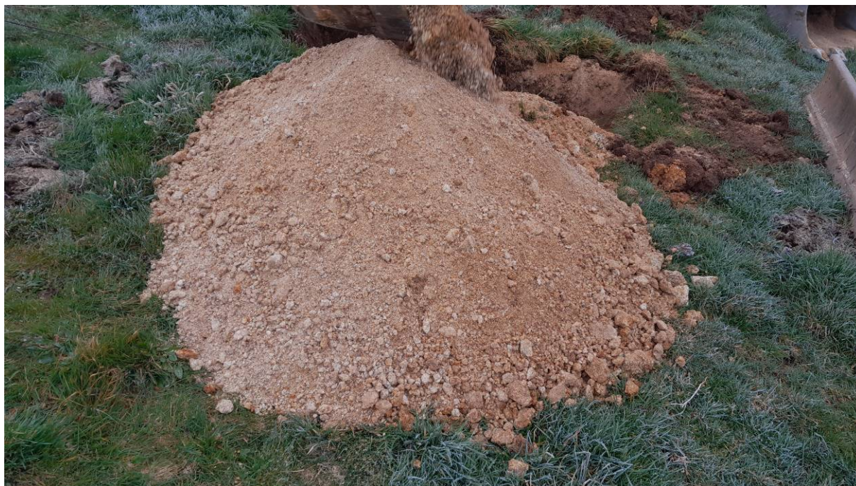
0.2-1.4 m : Sable graveleux beige de plus en plus graveleux et compact (arène granitique)
