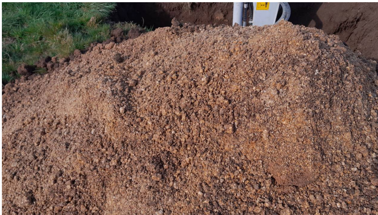
1.3-1.9 m : Sable graveleux beige de plus en plus graveleux et compact (arène granitique)
