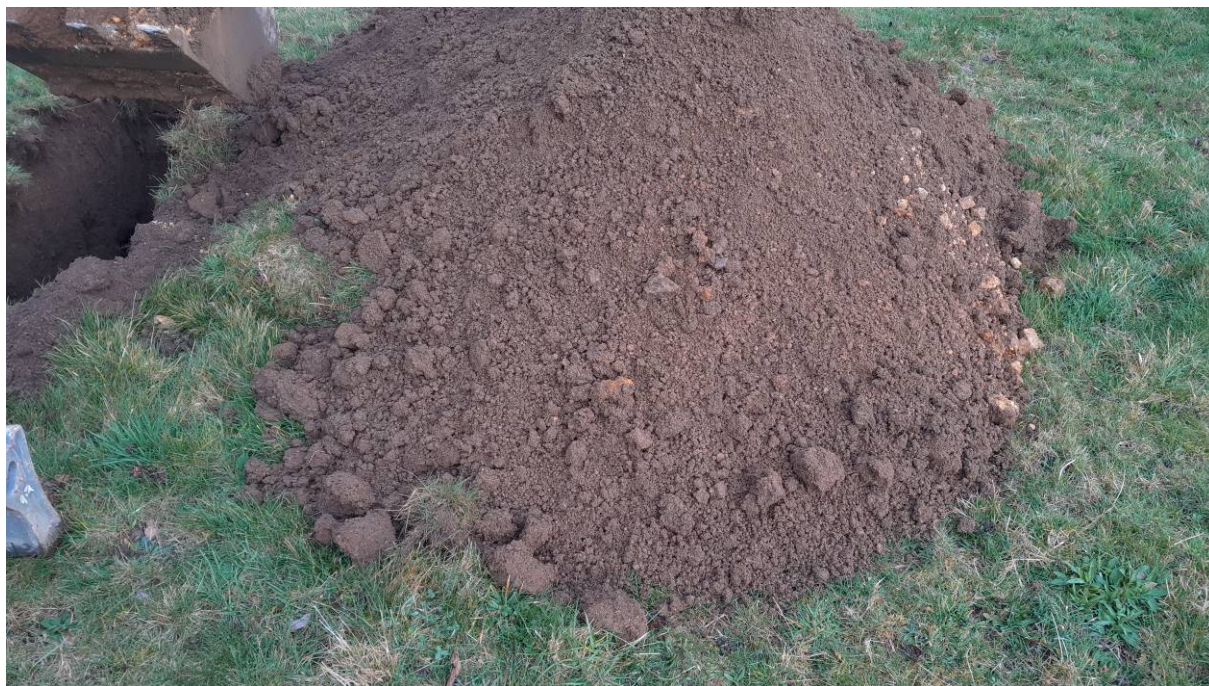
0.1-1.1 m : Sable limono-graveleux marron avec racines (colluvions)
