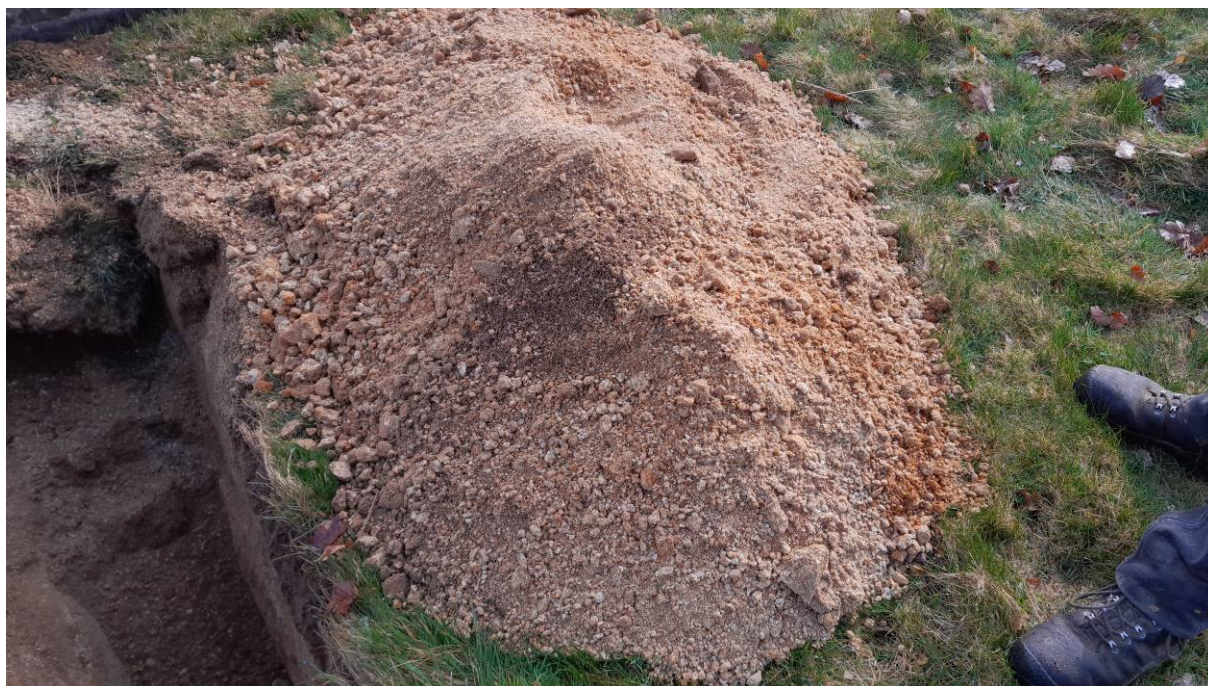
0.3-1.2 m : Sable graveleux beige de plus en plus graveleux et compact (arène granitique)
