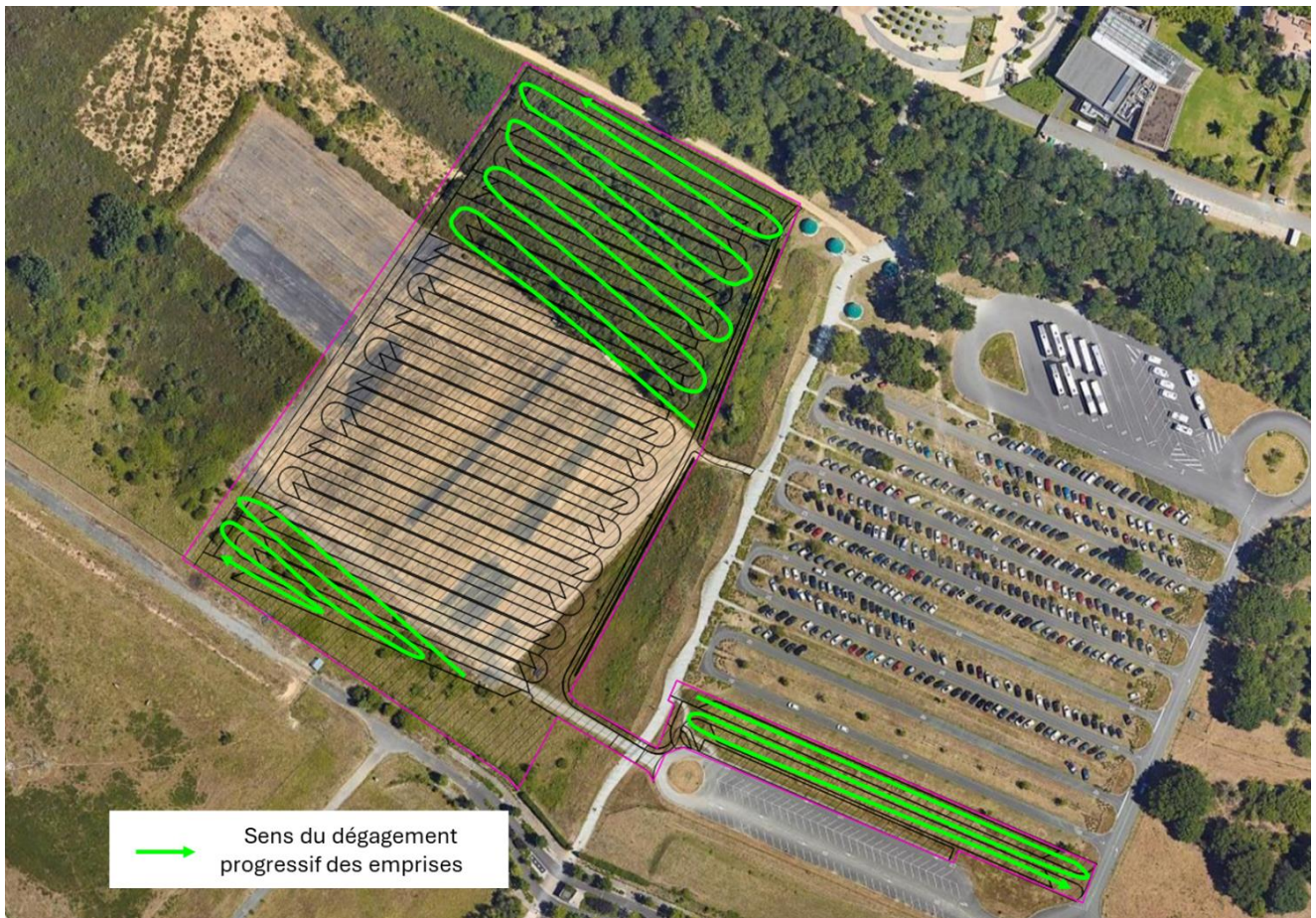
Figure 7 : Carte illustrant le dégagement progressif des emprises travaux (Source du fond de plan : Google satellite)
