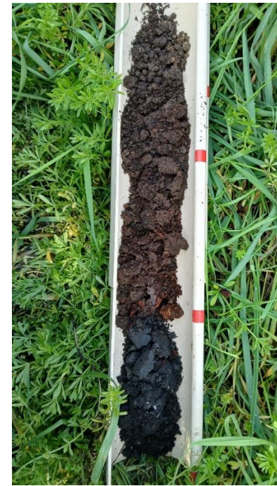
Profil illustrant les particularités du site (S07). Principalement composé de matière organique en décomposition. Aucune trace d'hydromorphie n'est visible en profondeur.
