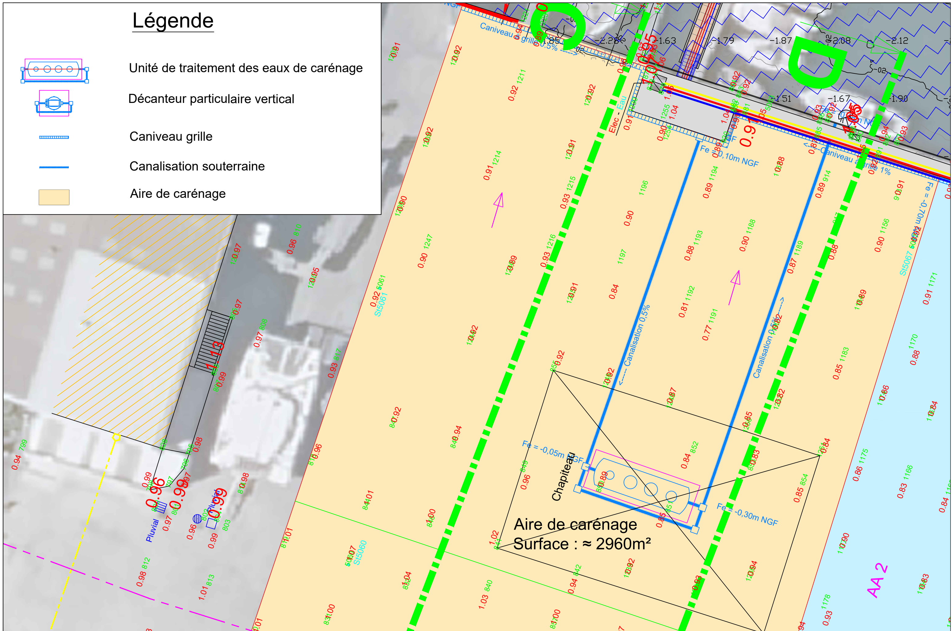
Vue en plan aire de carénage
