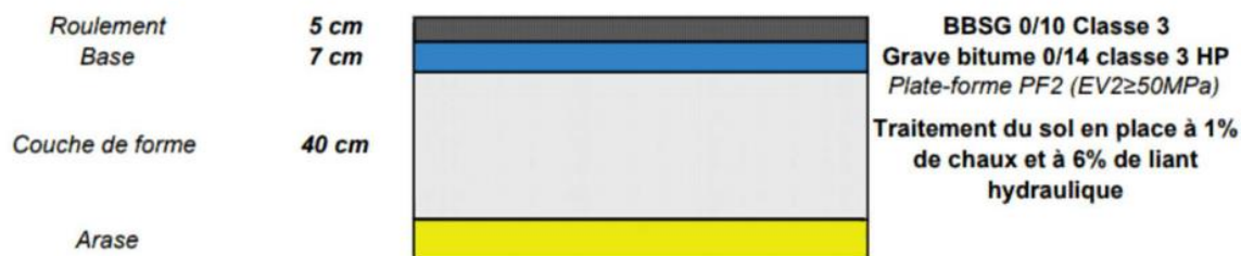
Figure 38 Exemple de structure de chaussée
