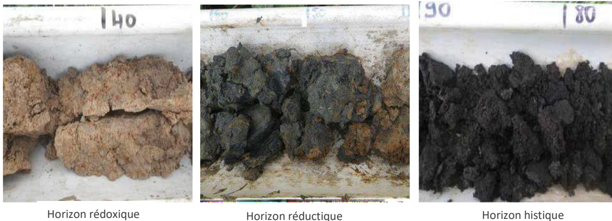
Figure 2 : Illustration de sondages pédologiques de sols humides
