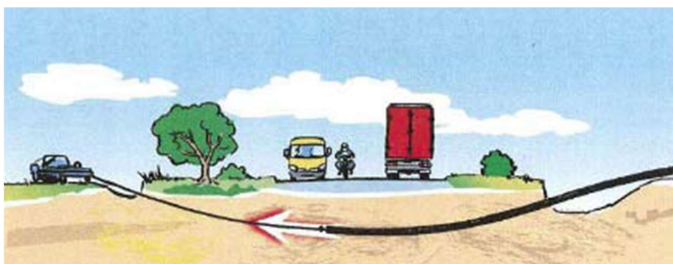
Schéma d'un passage en sous-œuvre en forage dirigé
