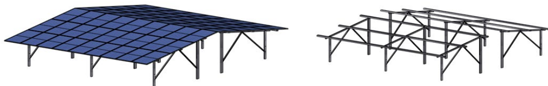
Figure 3 : Schéma des tables accueillant les panneaux photovoltaïques
