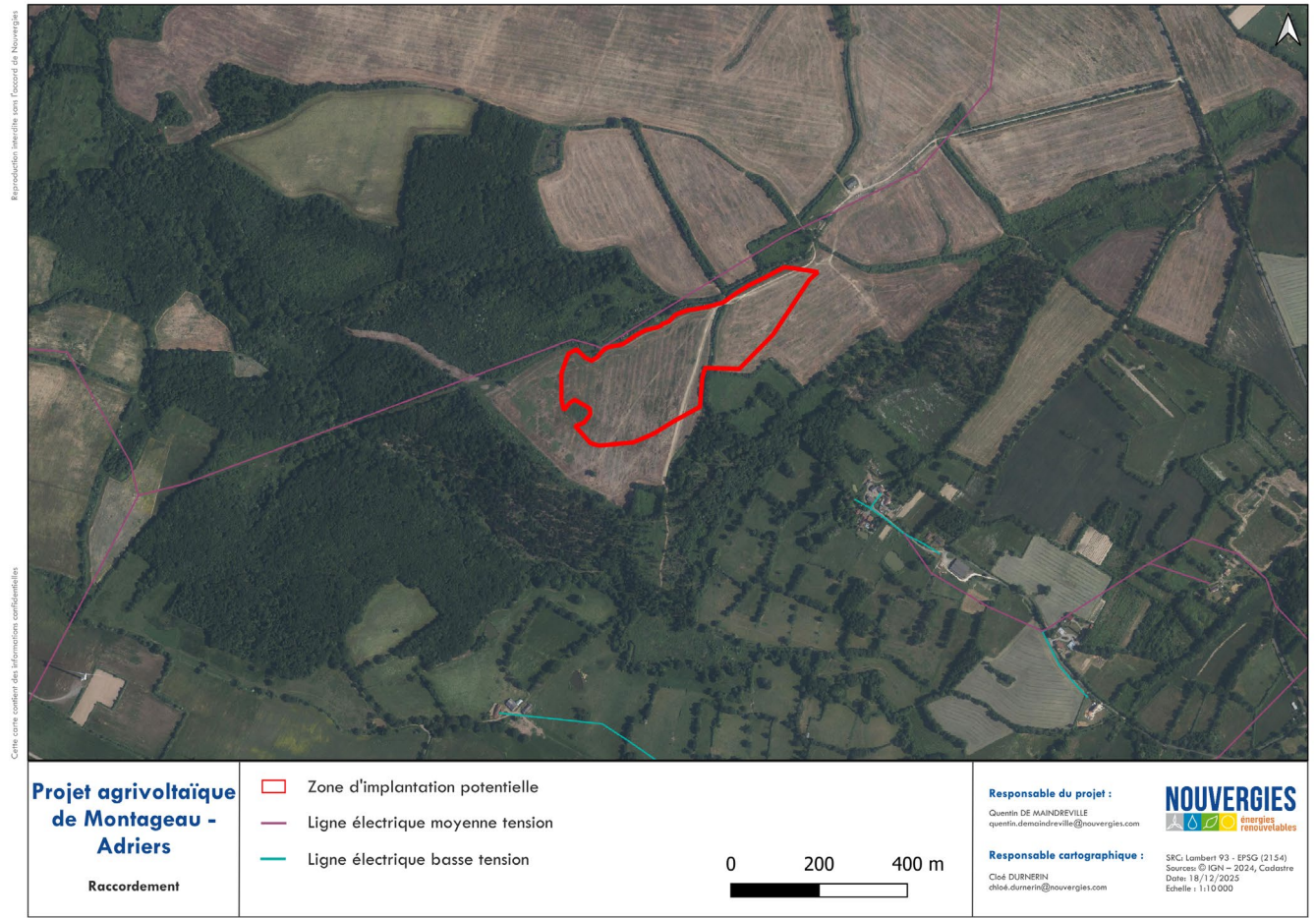
Figure 9 : Raccordement électrique (source : Nouvergies)
