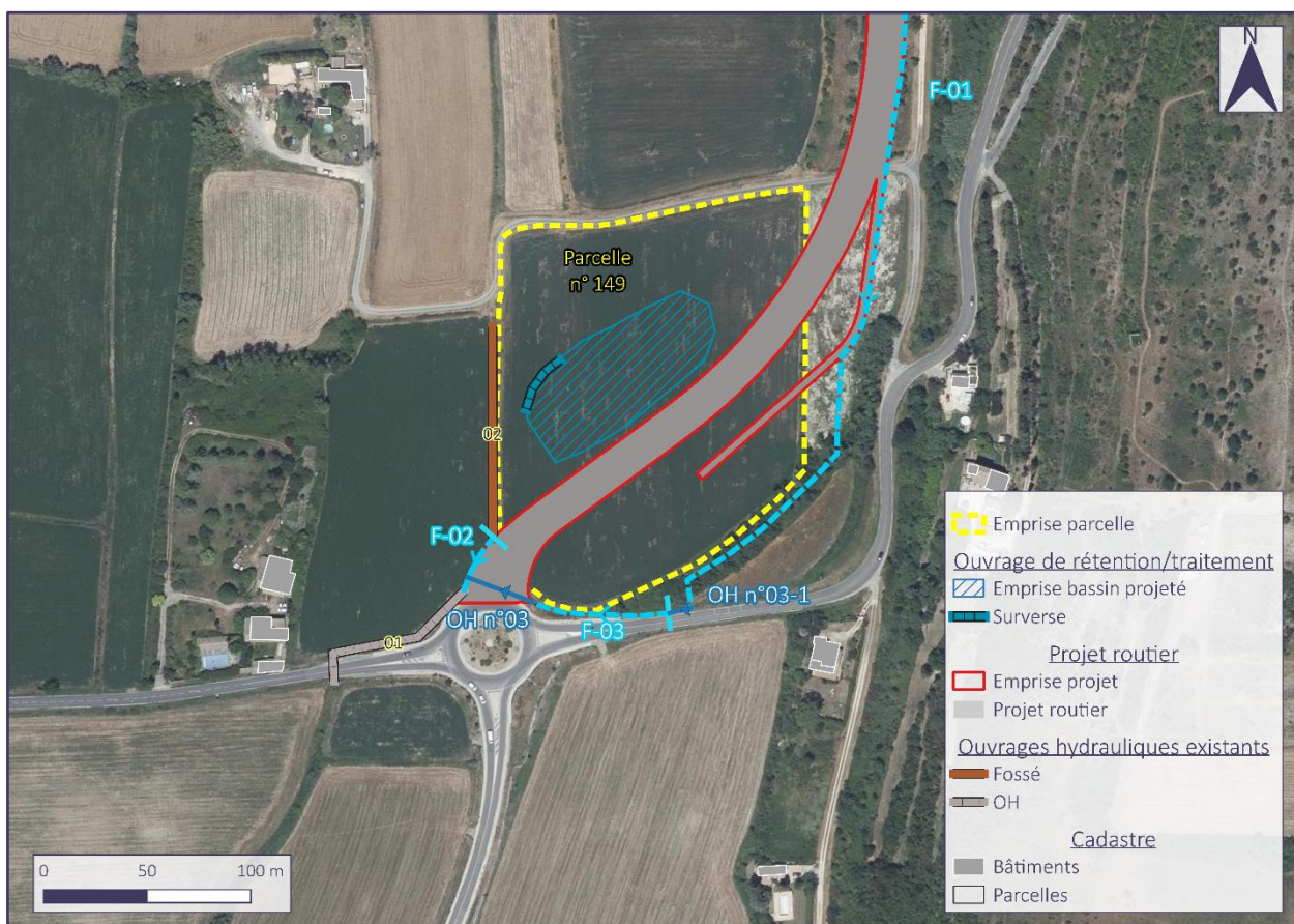
Figure 6. Emplacement bassin de rétention projeté
