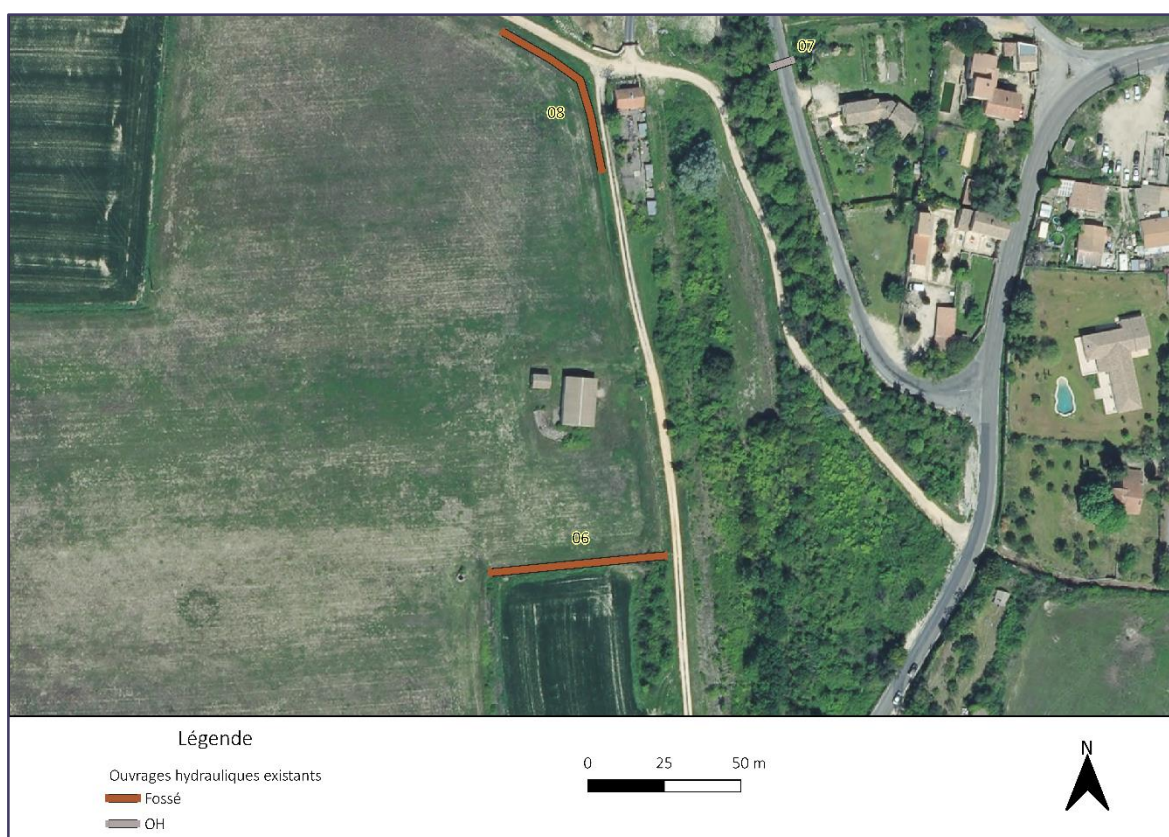
Figure 24. Localisation ouvrages hydrauliques existants - planche 3 sur 6
