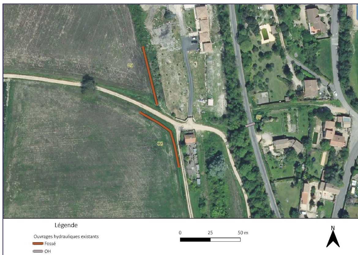
Figure 25. Localisation ouvrages hydrauliques existants - planche 4 sur 6
